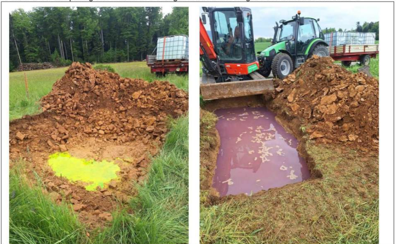
Foto 11: Wasserstand in Eingabestelle 1 beim Nachspülen
